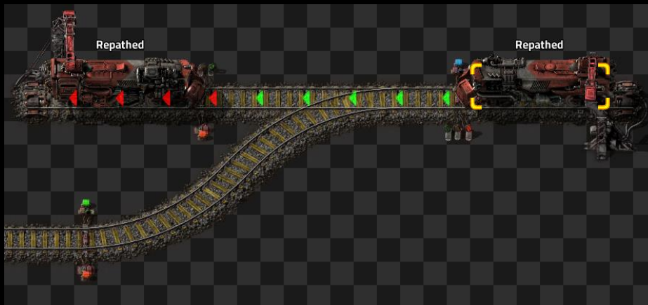
0.17 - Le train de droite est bloqué parce que la pénalité du train de gauche, qui dépend du temps, est réinitialisée à chaque fois que le train de gauche répète sa recherche de trajectoires.
